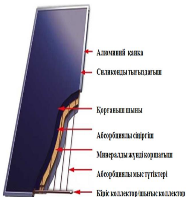
1.1 – сурет – Ж азық күн коллекторының жалпы құрамы
